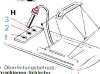
Für Oberleitungsbetrieb: Fahr-schienen-Schleifer abnehmen!
