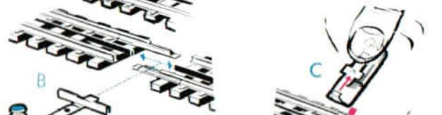
2) **Fahrschienen-Anschlußklemme** 56-6531-00: Kontaktschieber zurückziehen, Klemmen zwischen Schwellen durchstecken und Kontaktnase hinter Schienenfuß einhängen (C); Anschlußklemme an Schwellenkörper anlegen (D) und Schieber loslassen (E). – Eine komplette Anschlußstelle für zwei Fahrpulte (I und II) zeigt Bild F.
